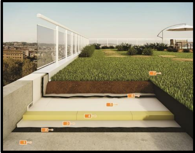
Sistema de Techo Verde con membranas bituminosas 1 Soporte 2 Promotor de adhesión 3 Barreras de vapor 4 Aislante térmico 5 Primera capa de membrana bituminosa 6 Segunda capa de membrana bituminosa 7 Doble capa de separación 8 Elemento de amortiguación 9 Mortero 10 Geocompuesto de drenaje y protector 11 Medio de cultivo
